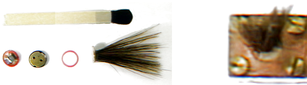
Abbildung 3-18 links: Einzelteile eines dynamischen Sensors im Größenvergleich mit einem Streichholz. Von links: Grundplatte mit Wandler IC, starre Membran, Distanzring, flexible Membran mit Tastfasern. Der Radius der Einzelkomponenten beträgt 2 mm. rechts: dynamischer Sensor in Trägerplatte montiert.
