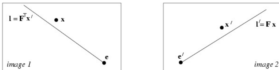
Abbildung 7.2: Die Abbildungen der Situation aus Abb. 7.1 in den Bildebenen
